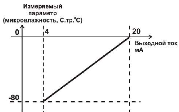
Рисунок 5.3 Линейный выход 4...20мА по диапазону влажности -80...0 °С по точке росы
